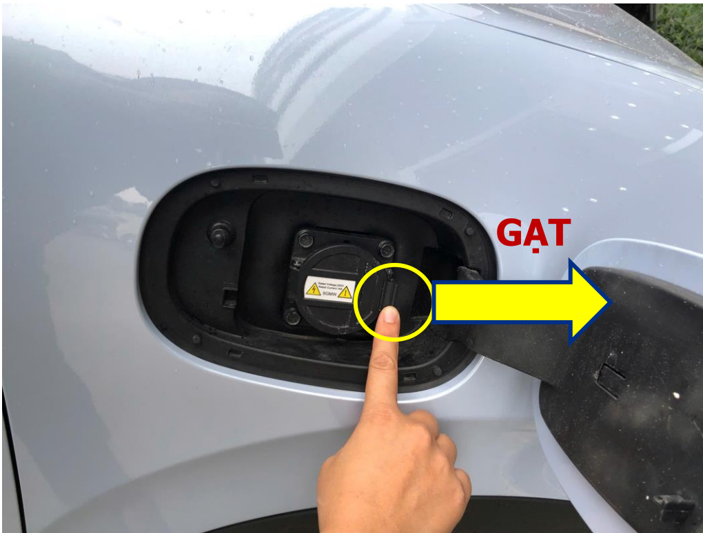
Gạt nắp cổng sạc phía trong sang phải để đóng nắp cổng sạc
